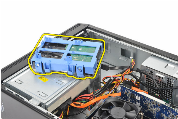
6. דחף את שתי הלשוניות מחוץ לכונן הקשיח והרם את הכונן הקשיח מתושבת הכונן הקשיח.
