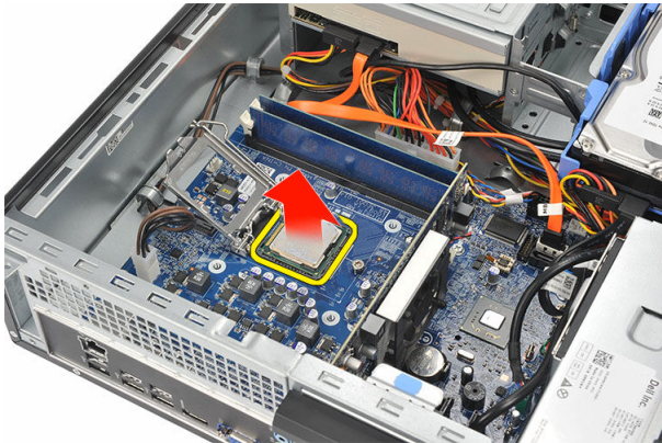
8. הרם את המעבד כדי להסירו מהשקע ולאחר מכן הנח אותו באריות הגנה מפני חשמל סטטי.
